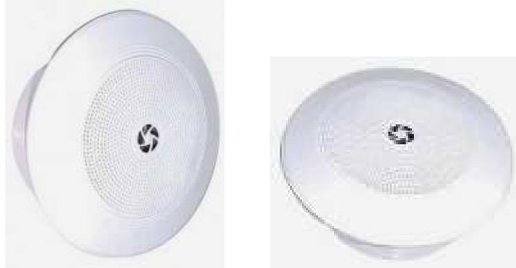
Parlante para sistemas busca-personas y música funcional con sistema de anclaje para embutir en cielorrasos de placas de roca de yeso (Durlock) o de yeso armado. Debido a su amplio rango de frecuencias y a su terminación, puede ser utilizado en oficinas, clínicas, confiterías, etc. El gabinete está construido en PVC de alto impacto color blanco. Equipado con transformador de línea de 70/100 Volts.
